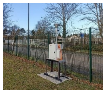
Figure 6 : Partisol utilisé pour le prélèvement d'air
