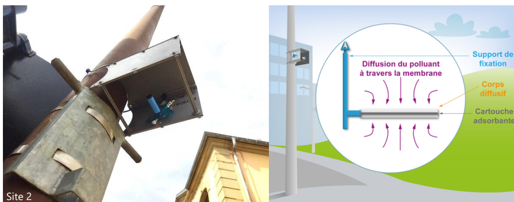
Figure 1 : principe des prélèvements passifs par tubes Radiello©
