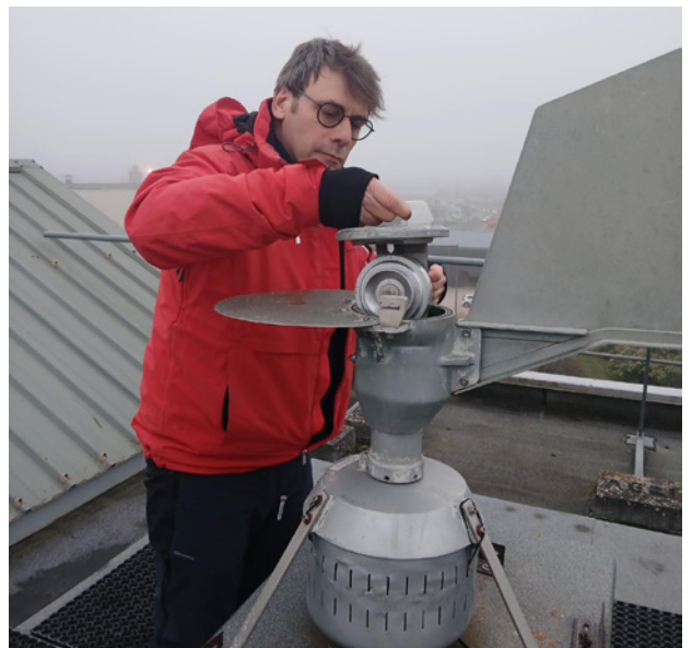
Mise en place du prélèvement de pollens dans le capteur de Chalon-sur-Saône ce lundi 20 janvier par un technicien Atmo BFC (Crédit photo : © Atmo BFC)
